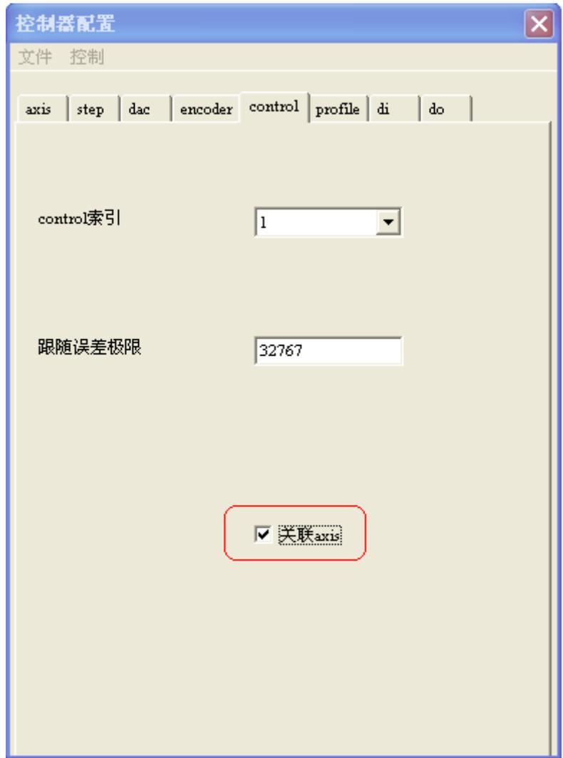
图 4-38 闭环配置示例之 control 配置界面
