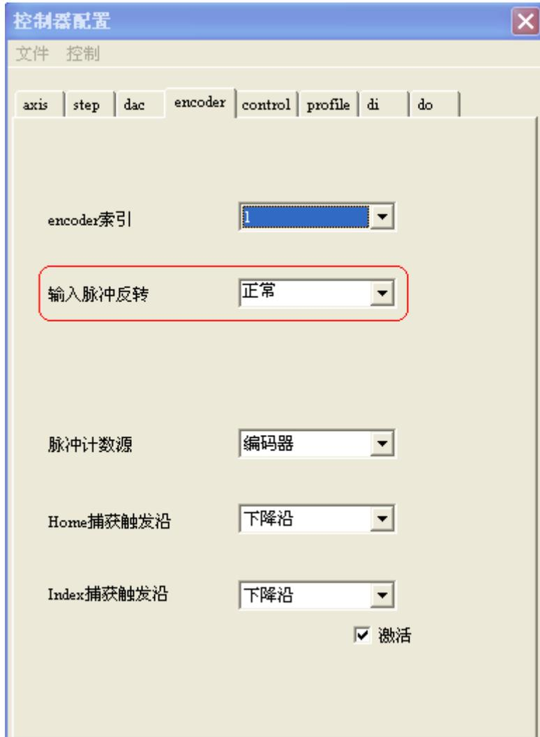
图 4-37 闭环配置示例之 encoder 配置界面
