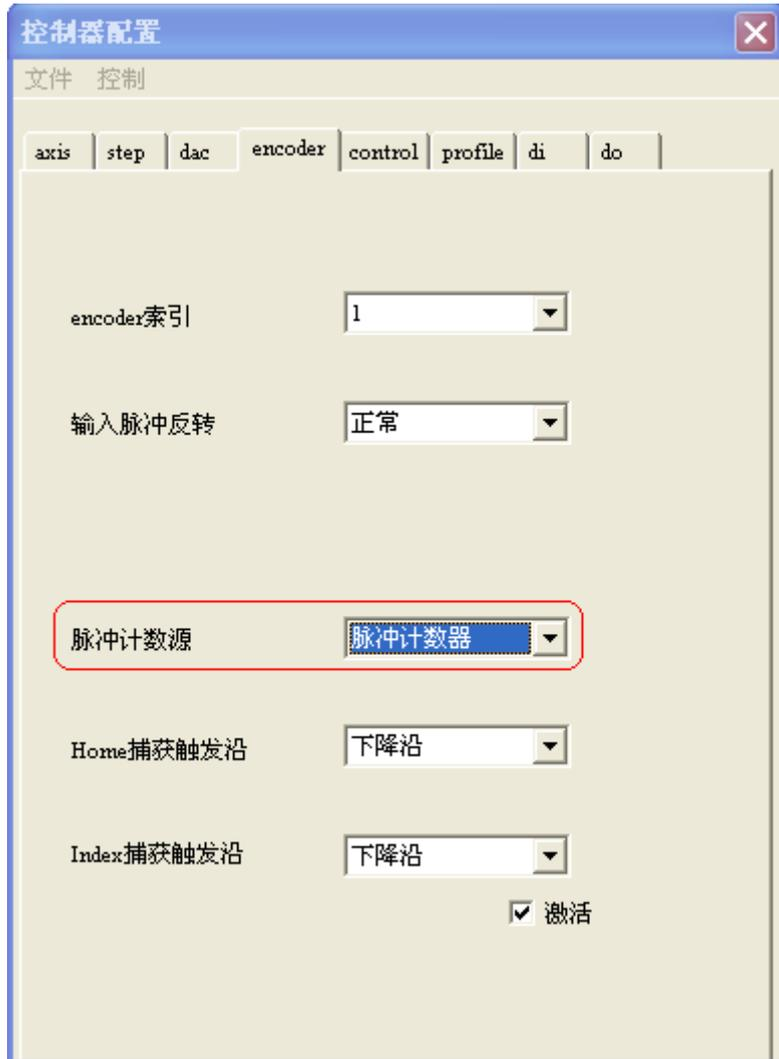
图 4-23 开环配置示例之 encoder 配置界面
