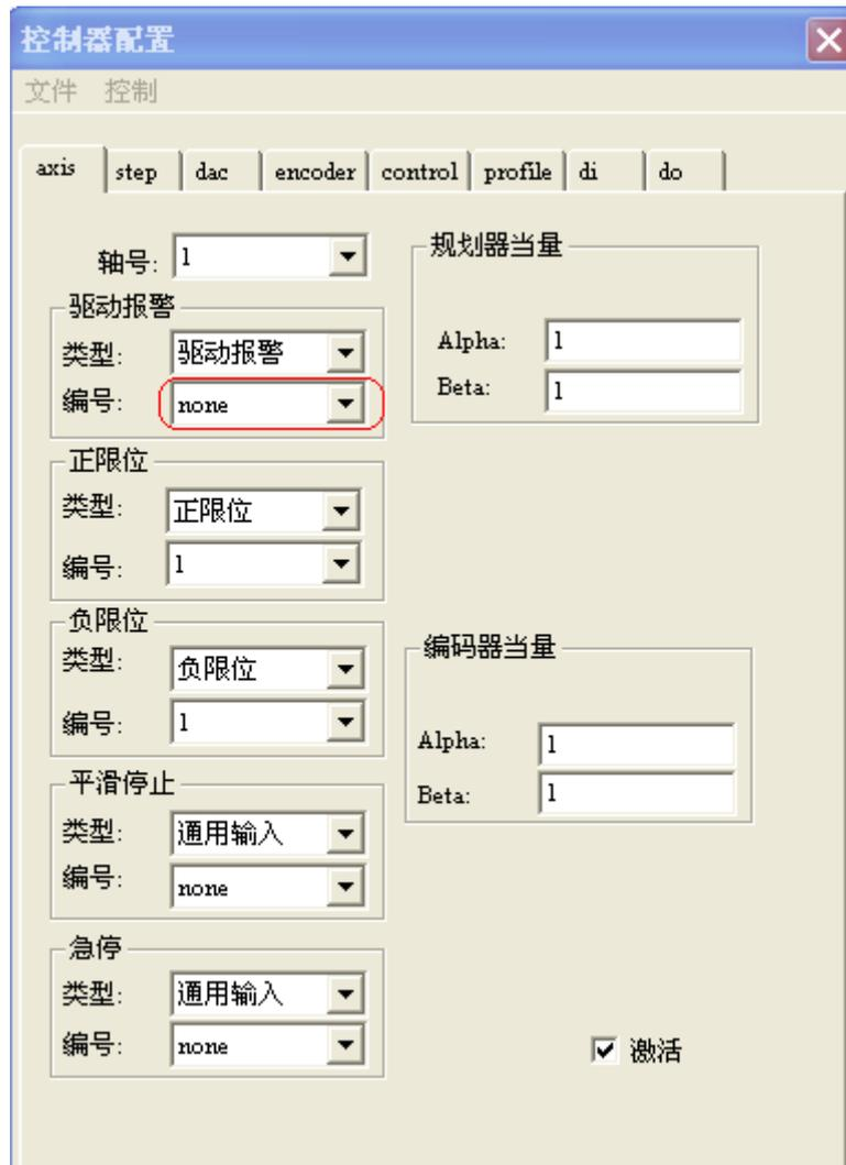
图 4-22 开环配置示例之 axis 配置界面
